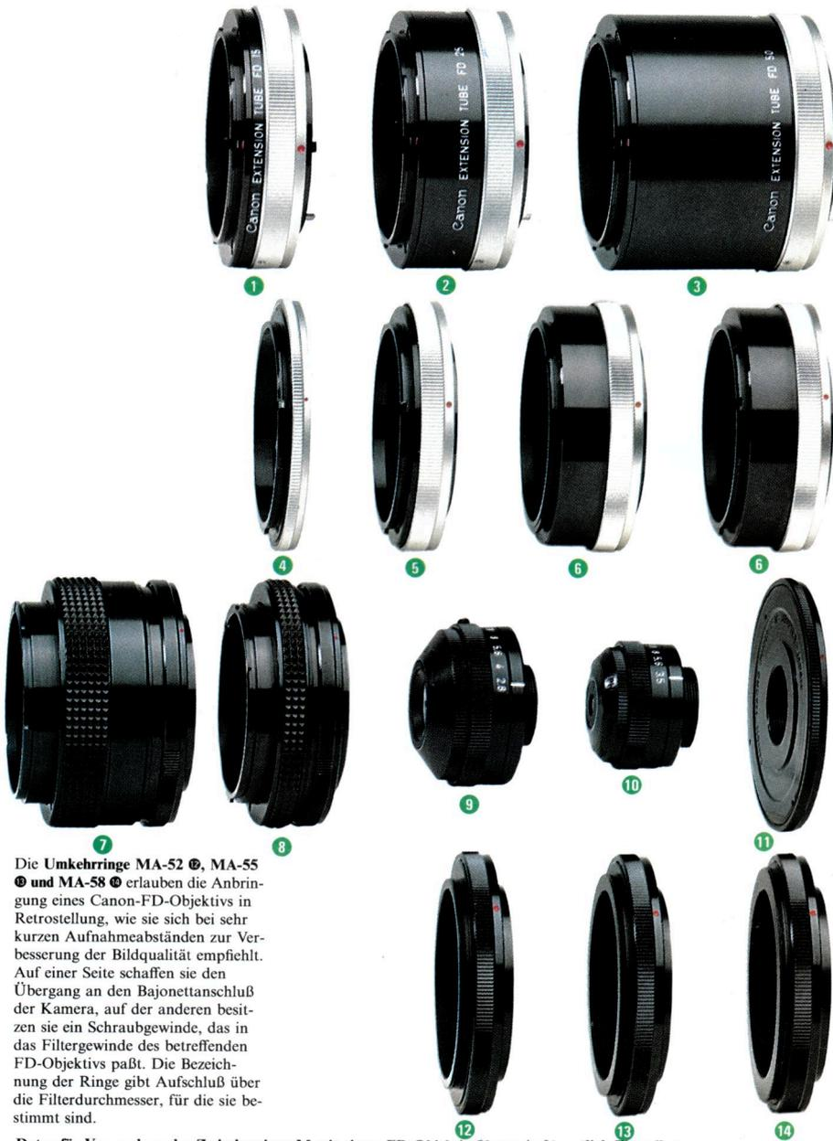
Die Umkehringe MA-52 ⑦, MA-55 ⑧ und MA-58 ⑨ erlauben die Anbringung eines Canon-FD-Objektivs in Retrostellung, wie sie sich bei sehr kurzen Aufnahmeabständen zur Verbesserung der Bildqualität empfiehlt. Auf einer Seite schaffen sie den Übergang an den Bajonettanschluß der Kamera, auf der anderen besitzen sie ein Schraubgewinde, das in das Filtergewinde des betreffenden FD-Objektivs paßt. Die Bezeichnung der Ringe gibt Aufschluß über die Filterdurchmesser, für die sie bestimmt sind.
