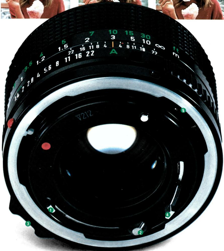
➊ Dieser Hebel ist charakteristisch für Canon-FD-Objektive. Er arbeitet bei allen Objektiven in gleichen Schritten und gibt die vorgewählte Blende in das Meßwerk der Kamera ein. Die Irisblende selbst bleibt dabei voll geöffnet, damit Ihr Sucherbild stets so hell wie möglich ist.
