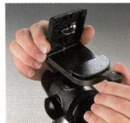
Einsetzen der Schnellwechsel-Platte: Beim Herunterdrücken schnappt die Platte ein und wird automatisch fixiert.
